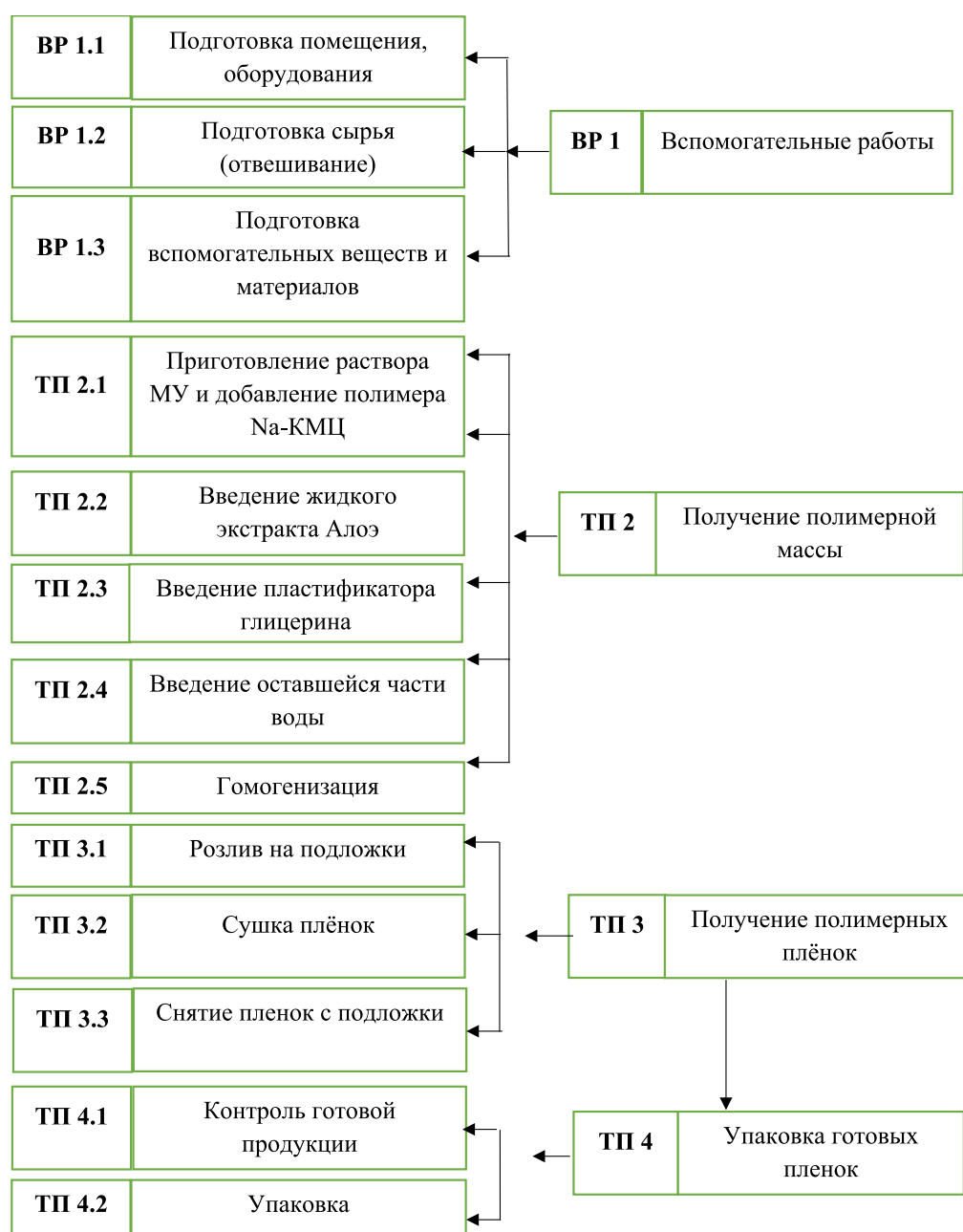
Рис. 1. Схема технологического процесса получения фитоплёнок по оптимальному 3-варианту технологии
