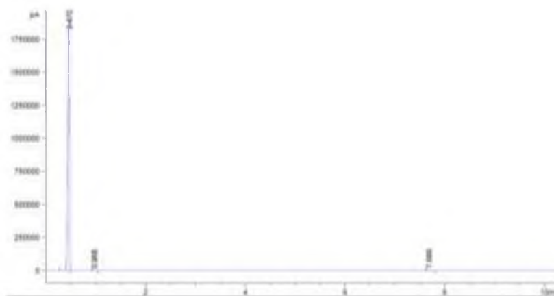
Рисунок 23. Хроматограмма раствора бланк. В хроматограмме видно, что кроме пиков циклогексана (время удерживания – 0,470 мин.) и внутреннего стандарта 3-циклогексилпропионовой кислоты (время удерживания – 7,689 мин.) нет других пиков.
