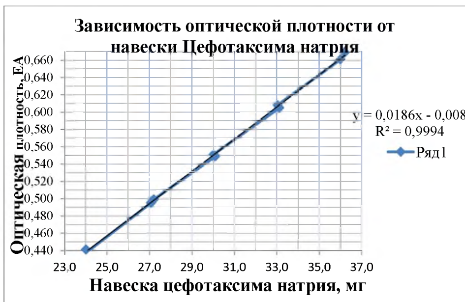
Рисунок 26. Диаграмма зависимости оптической плотности от концентрации цефотаксима натриевой соли в растворе.
